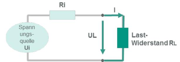
Die in burster Batteriemesssystemen zur Anwendung kommende AC/DC-Innenwiderstands-Messmethode (Zweifrequenzmessung) eignet sich ideal für eine lückenlose vollautomatisierte Serienfertigung, um im Vorfeld gravierende Ausfälle zu vermeiden.
