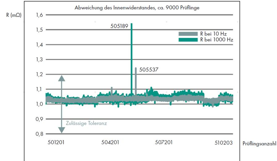
Im Vergleich ist erkennbar, dass bei ca. 9000 Prüflingen ohne die zusätzliche AC/DC-Messung **2 Ausreißer nicht erkannt worden** wären!
