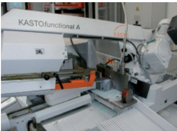
Die Schwenkrahmenmaschine «KASTOfunctional» arbeitet mit einer Schnittgeschwindigkeit von 110 m/min. (Bilder: Kasto)
