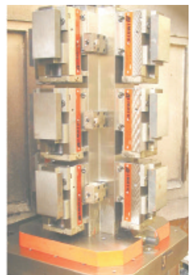
Bild 10. Der Turm ist auf jeder der vier Seitenflächen mit drei hydraulischen Spannelementen «AF-C» bestückt.
