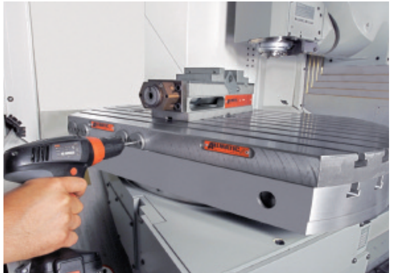
Bild 9. Rationelles Spannen mit Innensechskantschlüssel oder Akkuschauber.
