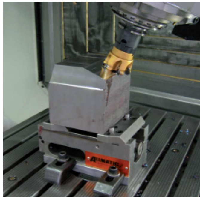
Bild 5. Optimale Zugänglichkeit für eine Fünfseitenbearbeitung.
