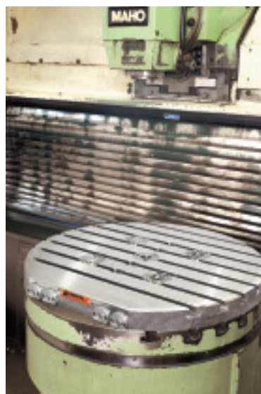
Bild 8. Mit dem Nullpunktspannsystem QC-1200 in Rundtischausführung nachgerüstete Fräsmaschine.
