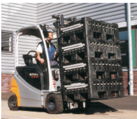
Bild 2. Gabelstapler mit dreiteiligem Kamera-Monitor-System für bessere Sichtverhältnisse.
