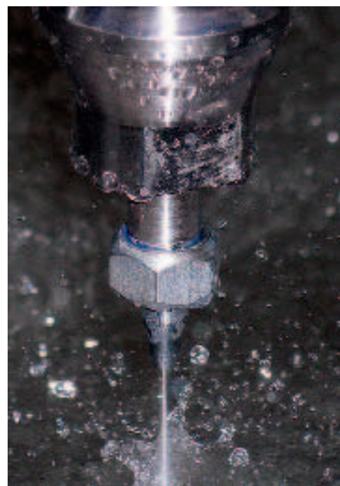
Den Wasserstrahl radikal verkleinern und mit Höchstpräzision führen, ist Forschungsschwerpunkt am Schweizer Kompetenzzentrum für Wasserstrahltechnologie (SKWT). Im Bild ein abrasiver Präzisionswasserstrahl mit d = 0,2 mm. (Bild: Waterjet AG)
