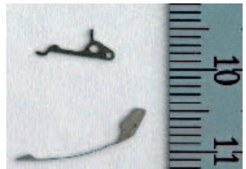
Abrasive Wasserstrahltechnologie ist oft die einzige Methode für die Bearbeitung hochsensibler Mikrokomponenten, um thermische Belastungen und Gefügeveränderungen zu verhindern. Im Bild mit AWJmm-Technologie geschnittene Präzisionskleinstteile.
