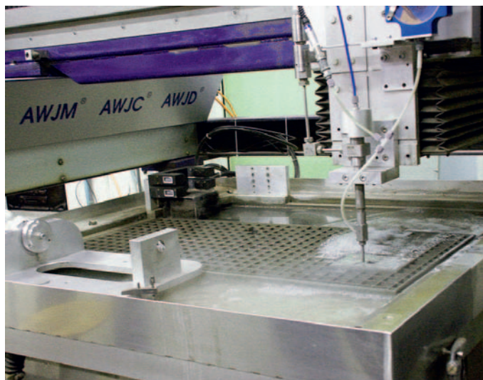
Unterstützt von Industriepartnern, vor allem der Waterjet AG, baut die Crew von Professor Heiniger eine in der Schweiz einmalige Infrastruktur auf, wie diese Prototypanlage einer Präzisions-schneidmaschine, im Bild in Betrieb mit einem klassischen Schneidkopf. (Bild: Elsbeth Heinzlmann)
