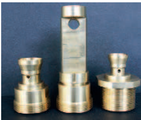
Messingdrehteile, in der Mitte der Überspannungsableiter für Mobiltelefon-Sende- und -Empfangsstationen.
