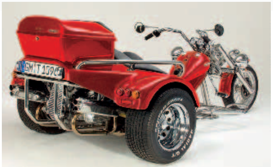
Kofferraumschalen und Kotflügel eines Trikes (Rewaco).
