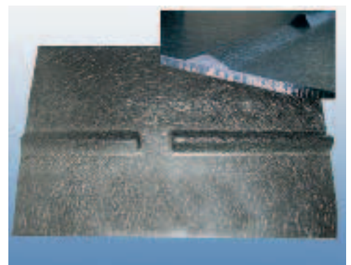
Versteifungsrippe auf einem CompuTec-Bauteil, erzeugt durch lokalen Einsatz des FipurTec-Verfahrens.
