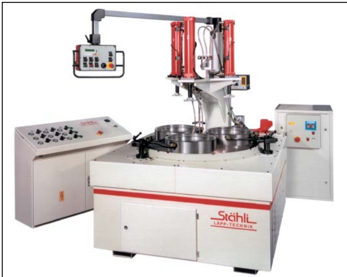
Bild 1: Leistungsstarke Einscheiben Läpp- und Flachhon-Maschine FLM 1000, mit CBN-Arbeitsscheibe, Kühlung, Pneumatik und angetriebenen Aufnahme-Ringen
