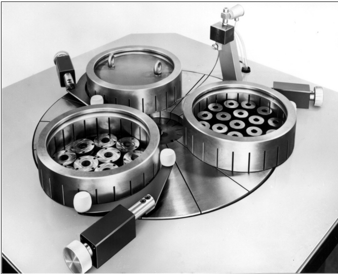
Bild 1: Einscheiben-Läppmaschine mit drei Abrichtringen. Die Druckplatte ermöglicht die Parallel-Bearbeitung in höchster Qualität.
