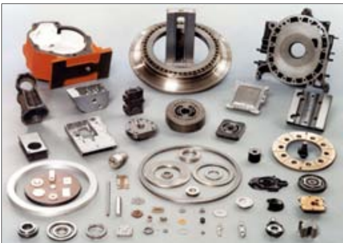
Bild 2: Geläppte Werkstücke, mehrheitlich für die Einscheiben-Technik
