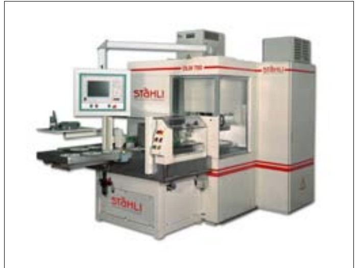
Bild 7: DLM 700 Vollautomatik, ab vorbeladener Warte-Station, innerhalb 30 Sekunden beladen und entladen
