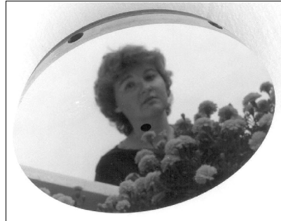
Bild 3: Hochglanzgeläppte Spritzgussform aus Stahl. Einsatz für das CD-Spritzwerkzeug, Oberfläche im Nano-Bereich Ra 0.001 Mikron (10A)
