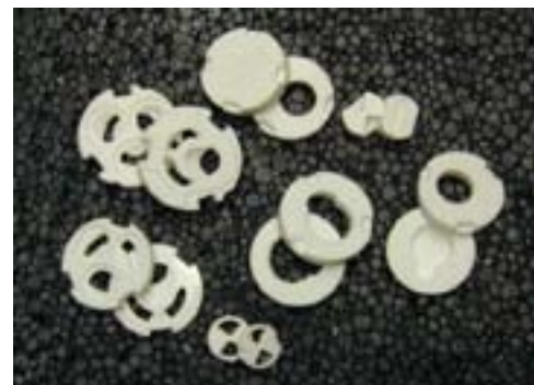
Bild 4: Flachgehonte Keramik-Scheiben, Dichtfläche poliert auf Ra 0.01, Ebenheit <2 Lichtband 0.6 Mikron
