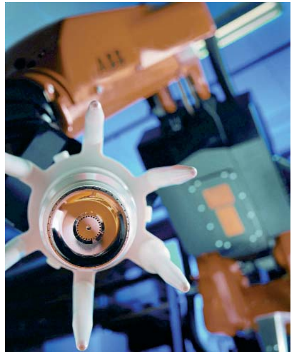
Hocheffizienter Rotationszerstäuber, ein ideales Lackierwerkzeug, das den hohen Anforderungen der Automobilindustrie entspricht
