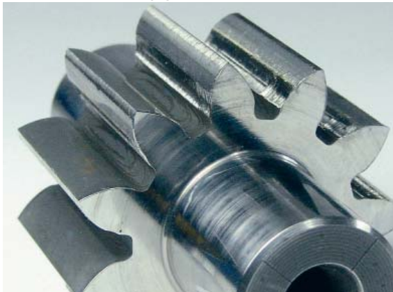
Bild 1: Abrasivverschleiss an der rechten Zahnflanke nach Einsatz mit Schleifkühlmittel
