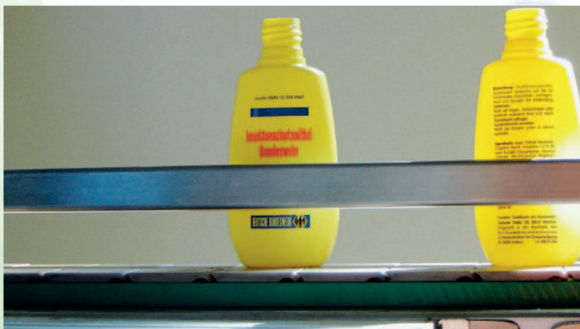
Abb. 4 Lagetoleranzen von bis zu \pm 15 mm sind für den Sensor unkritisch. Auch wenn die Flaschen «verdreht» auf dem Band stehen, werden sie sicher erkannt.
