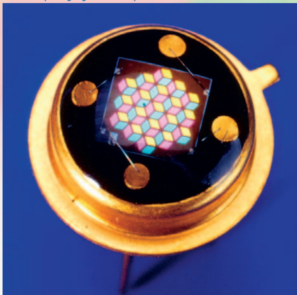
Abb. 5b Integriertes Empfängerelement mit Wabenstruktur. (Bild 5a/5b: MAZeT)
