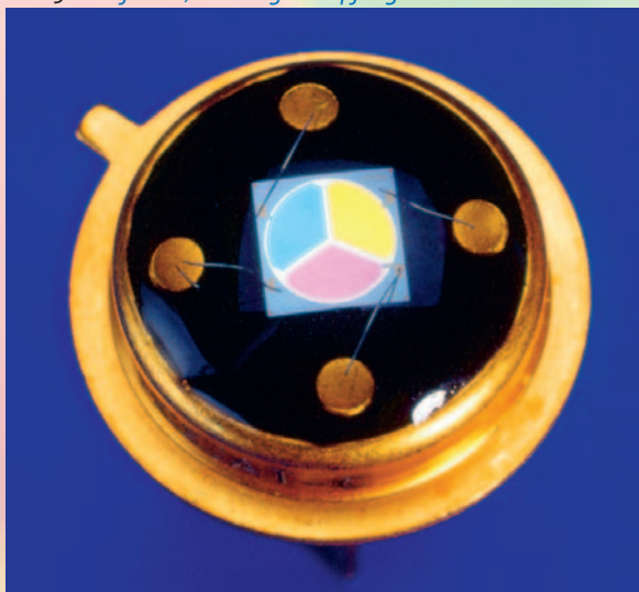
Abb. 5b Integriertes Empfängerelement mit Wabenstruktur. (Bild 5a/5b: MAZeT)
