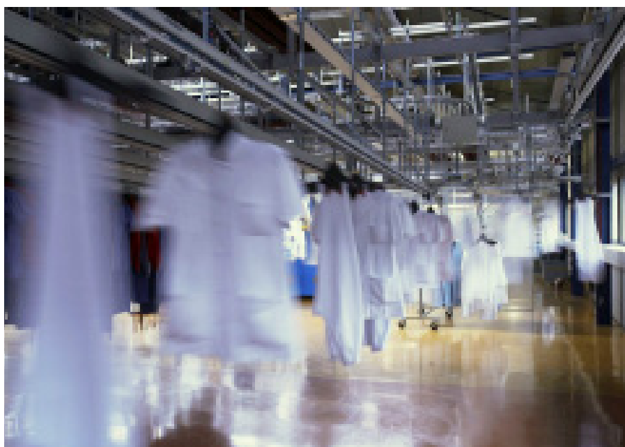
Förderstrecke für hängende Formteile bei der Inotex Bern AG.
