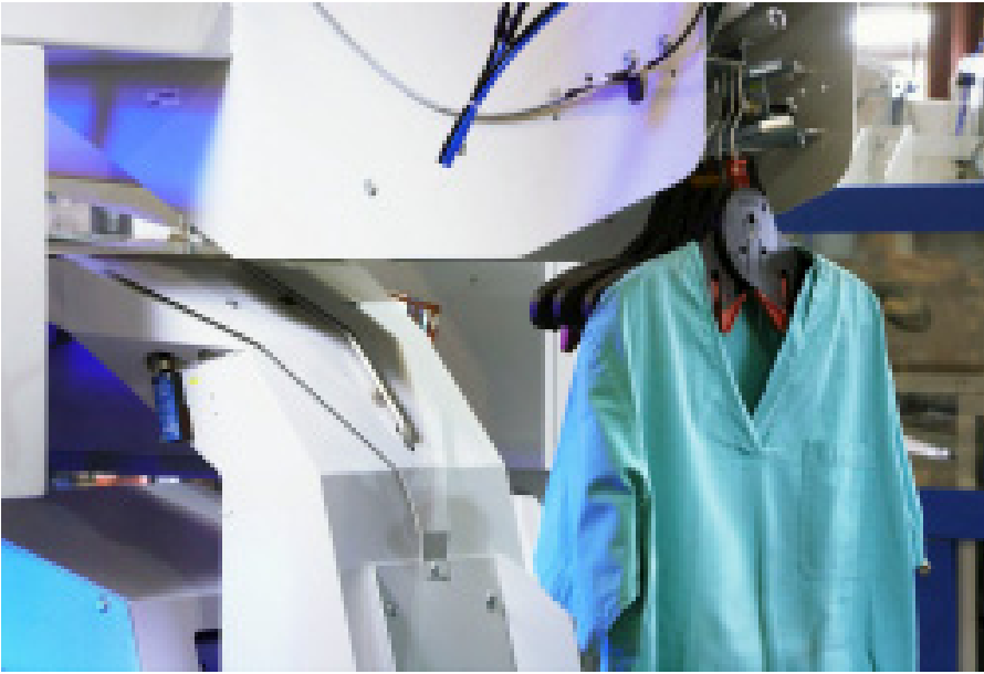
Formteilerkennung mit WT18-3 am Einlauf der Faltmaschine Butterfly Maximat.
