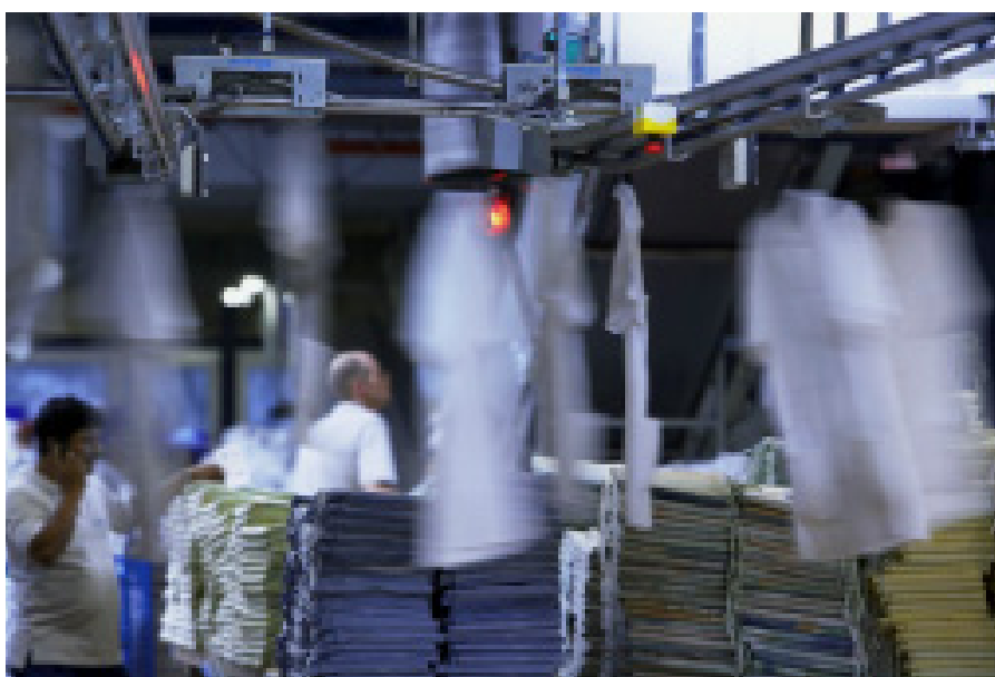
Die Weichen der Fördertechnik werden entsprechend der detektierten und identifizierten Kleiderbügel angesteuert. (Bilder: Sick AG)
