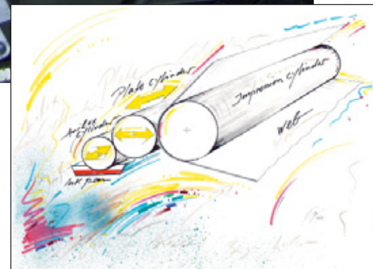
Ein typisches Anwendungsbeispiel für Schrittmotoren ist die Druckwalzenverstellung in Flexodruckmaschinen. (Bilder: Berger Lahr)
