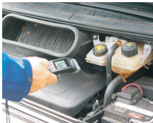
Überprüfen des Heizungssystems
