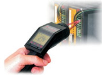
Detaillierte Infrarottemperaturmessung an einer elektrischen Steuerung mit Hilfe der eingebauten Scharfpunkt optik des optris LS im 1 Millimeterbereich
