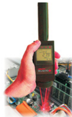
Hochgenaue Infrarottemperaturmessung mit dem optris LS an nur 1 mm kleinen SMD-Bauelementen beim Leiterplatten-Testlauf
