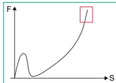
In diesem Bereich liegt meist auch das Messende, das für Gutteile immer erreicht werden muss. Die Überwachung der Blockkraft erfolgt mit den Kraftschwellen „Blockschwelle unten“ (die überschritten sein muss) und „Blockschwelle oben“ (die nicht überschritten werden darf).
