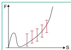
Bei Kraft-Weg-Schwellen muss die Kraft in diesem Bereich eine Mindestkraft übersteigen (Kraftschwelle unten). Sie darf aber diese Kraft anschließend in dem gesamten Bereich nicht mehr unterschreiten! Eine zweite Kraftschwelle, die „Kraftschwelle oben“ darf für Gutteile nicht überschritten werden.
