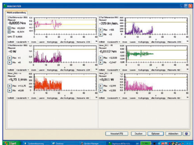
Screenshot P100: Mehrkanaldarstellung von zwei Sensoren, Drehmoment / Drehzahl / mechanische Leistung
