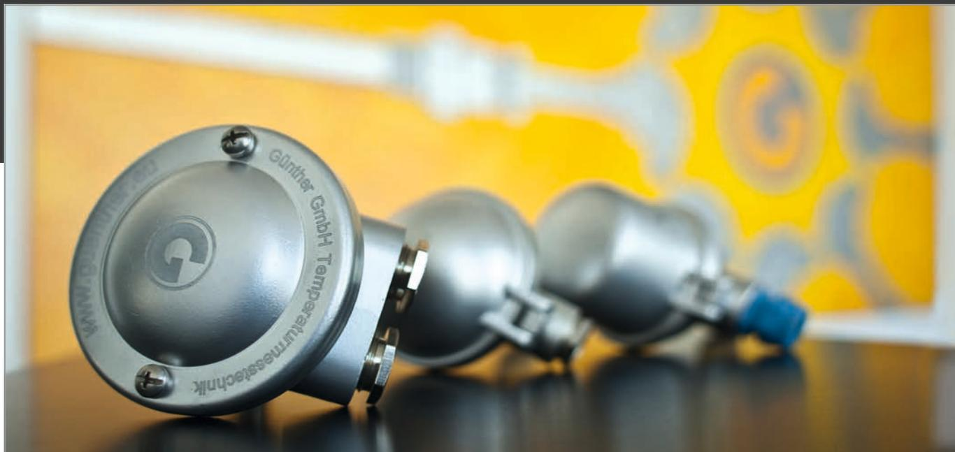
Alle Schutzarmaturen (prozessberührende Teile) werden einer Dichtheitsprüfung unterzogen. In den Armaturen sind Pt 100-Temperatursensoren nach DIN EN 60 751 in den Toleranzklassen A oder B in Zwei-, Drei-, oder Vier-Leitertechnik eingesetzt. Möglich sind auch Ausführungen mit zwei Messkreisen.
