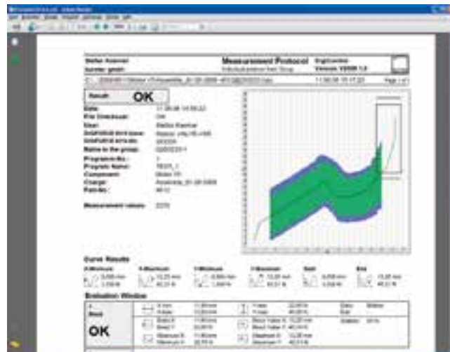
Bild: Ein Protokollassistent ermöglicht die gefilterte Auswahl und Darstellung von gespeicherten Messprotokollen. Zu jedem einzelnen Messprotokoll kann ein Protokollausdruck mit Bauteilinformationen, Kurvenverlauf und allen Bewertungsergebnissen generiert werden.
