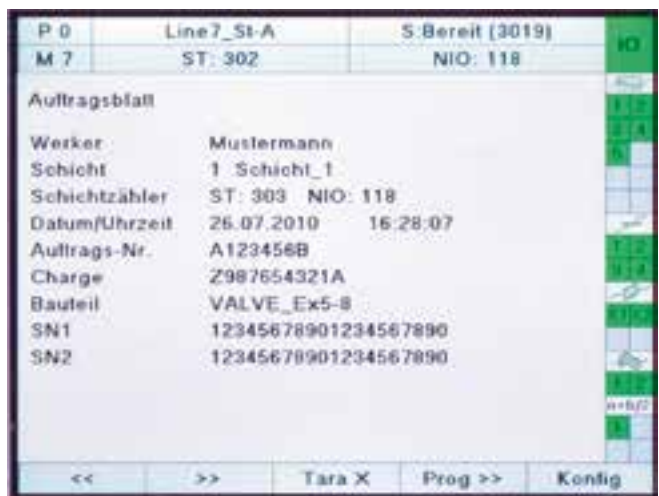
Bild: Das Auftragsblatt ermöglicht die Übergabe von administrativen und bauteilrelevanten Daten von der SPS zur PC-seitigen Prozessdatenprotokollierung.
