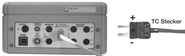
Abbildung 7: Messen von Temperaturen mit den Thermopaar-Buchsen
