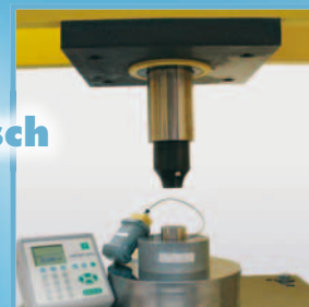
Kraftkalibrierung einer Presse
