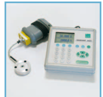
Kraftkalibrierung mittels DIGISTANT®, Smart-Sensor Interface und Kraftsensor
