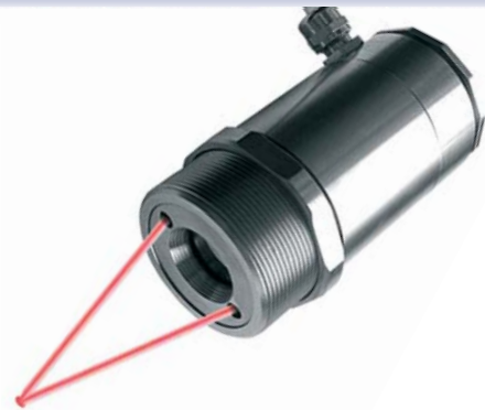
Doppel-Laservisier zur exakten Messfeldmarkierung in jeder Messentfernung, z.B. 0,5 mm in 150 mm Entfernung
