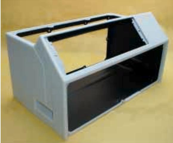
**Das Apparategehäuse in Zweikomponenten-Ausführung (630 x 370 x 350 mm): innen schwarzes leitfähiges PE und aussen hellgraues PE, das Bauteil wurde in Auftrag der Komax AG, Dierikon gefertigt.**
