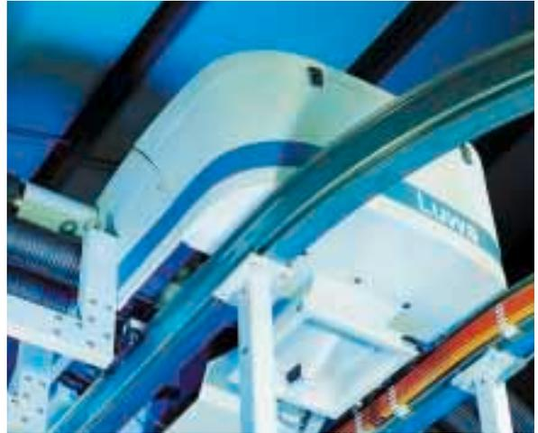
**Das Luftfilter-Gehäuse (Luwa AG, Uster) mit Deckel und integriertem Ventilator und Filtereinsatz wurde im Rotationsverfahren hergestellt und besitzt die Abmasse 1400 x 800 x 500 mm.**
